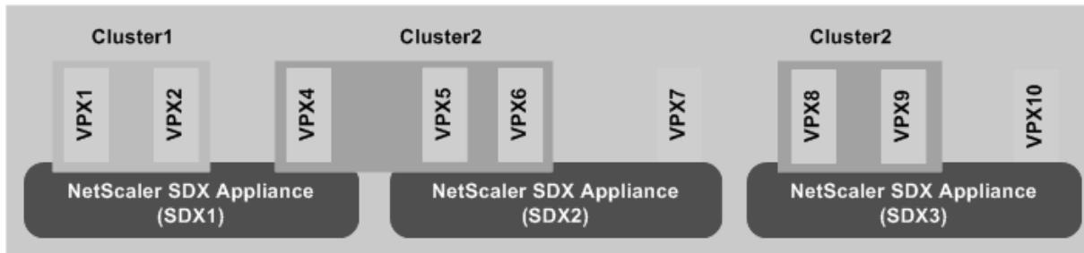
上图显示了同一子网中的三个 SDX 设备 SDX1、SDX2 和 SDX3。这些设备上的 Citrix ADC 实例用于形成两个群集：Cluster1 和 Cluster2。
