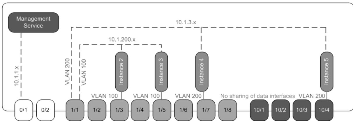
SDX 设备已连接到交换机。确保在设备端口 1/1 所连接的交换机端口上配置了 VLAN ID 100 和 200。
