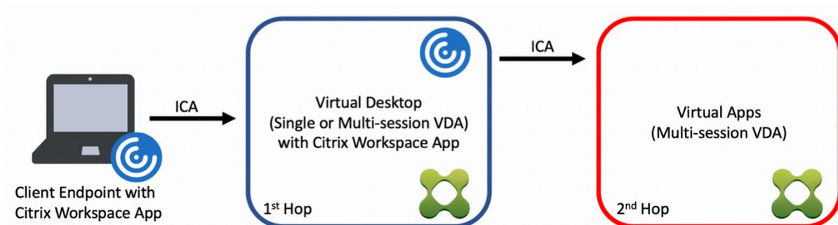
Wenn ein Benutzer in einem Double-Hop-Szenario eine Verbindung zu einem virtuellen Citrix Desktop herstellt, der auf einem Einzelsitzungs-OS-VDA ausgeführt wird (“VDI”) bzw. zu einem virtuellen Desktop, der auf einem Multisitzungs-OS-VDA ausgeführt wird (“veröffentlichter Desktop”), gilt dies als erster Hop. Nach Erstellen der Verbindung zum virtuellen Desktop kann der Benutzer eine Citrix Virtual Apps-Sitzung starten. Dies gilt als zweiter Hop.
