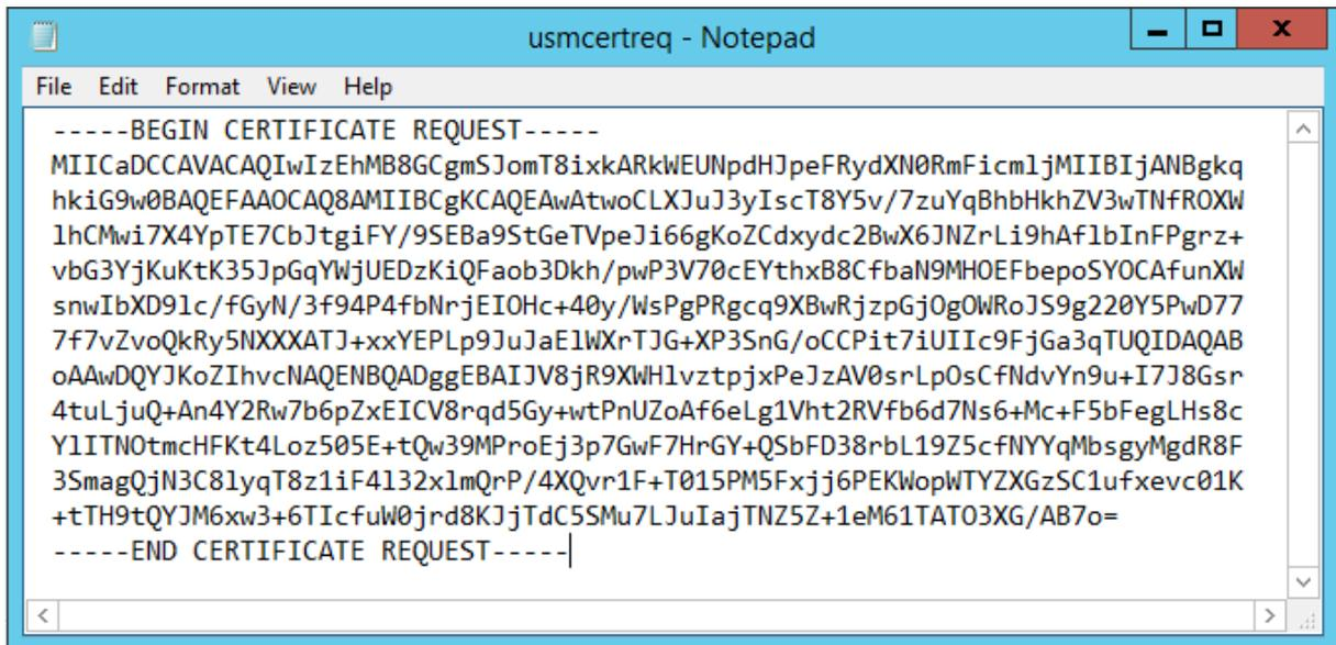
**Schritt 7:** Senden Sie die Zertifikatsignieranforderung an die Zertifizierungsstelle, indem Sie Folgendes in PowerShell auf dem FAS-Server eingeben:
