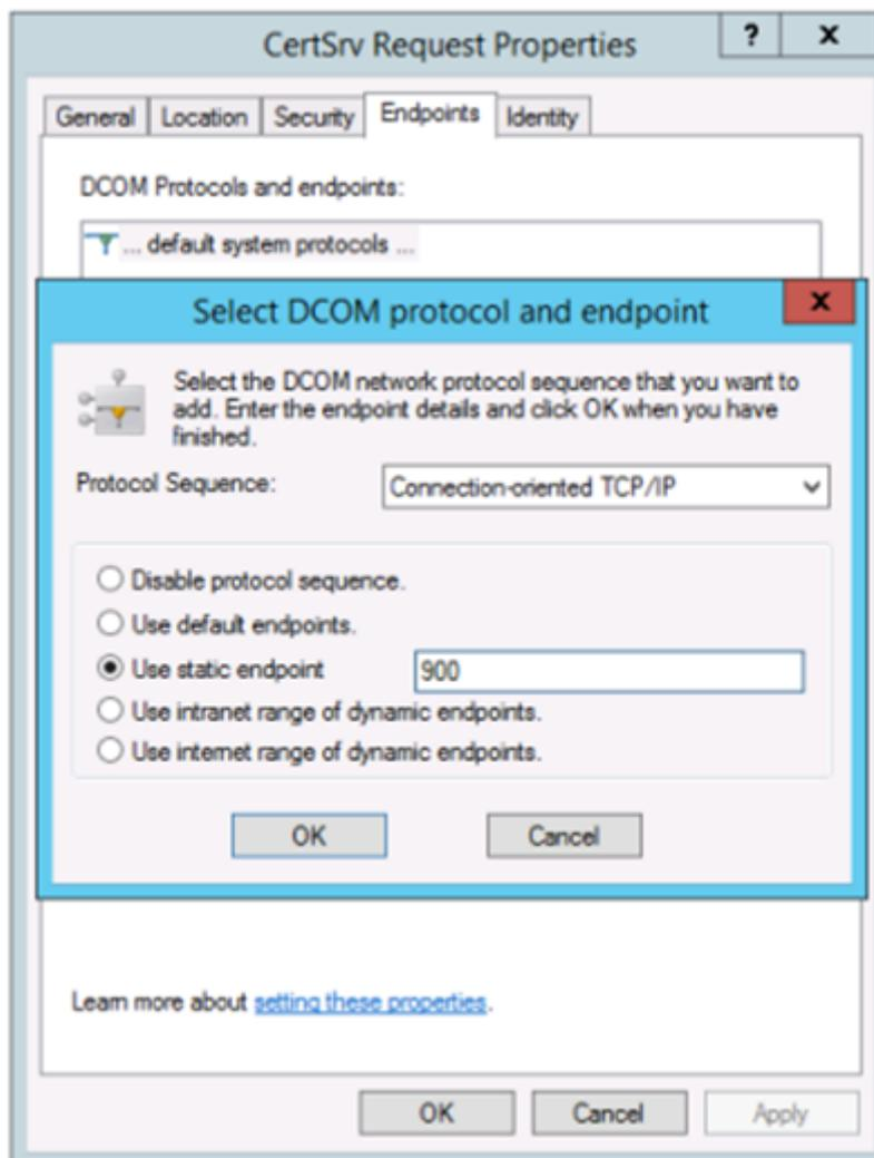
Ändern Sie die Endpunkte, indem Sie einen statischen Endpunkt auswählen, und geben Sie eine TCP-Portnummer ein (900 in der Abbildung oben).
