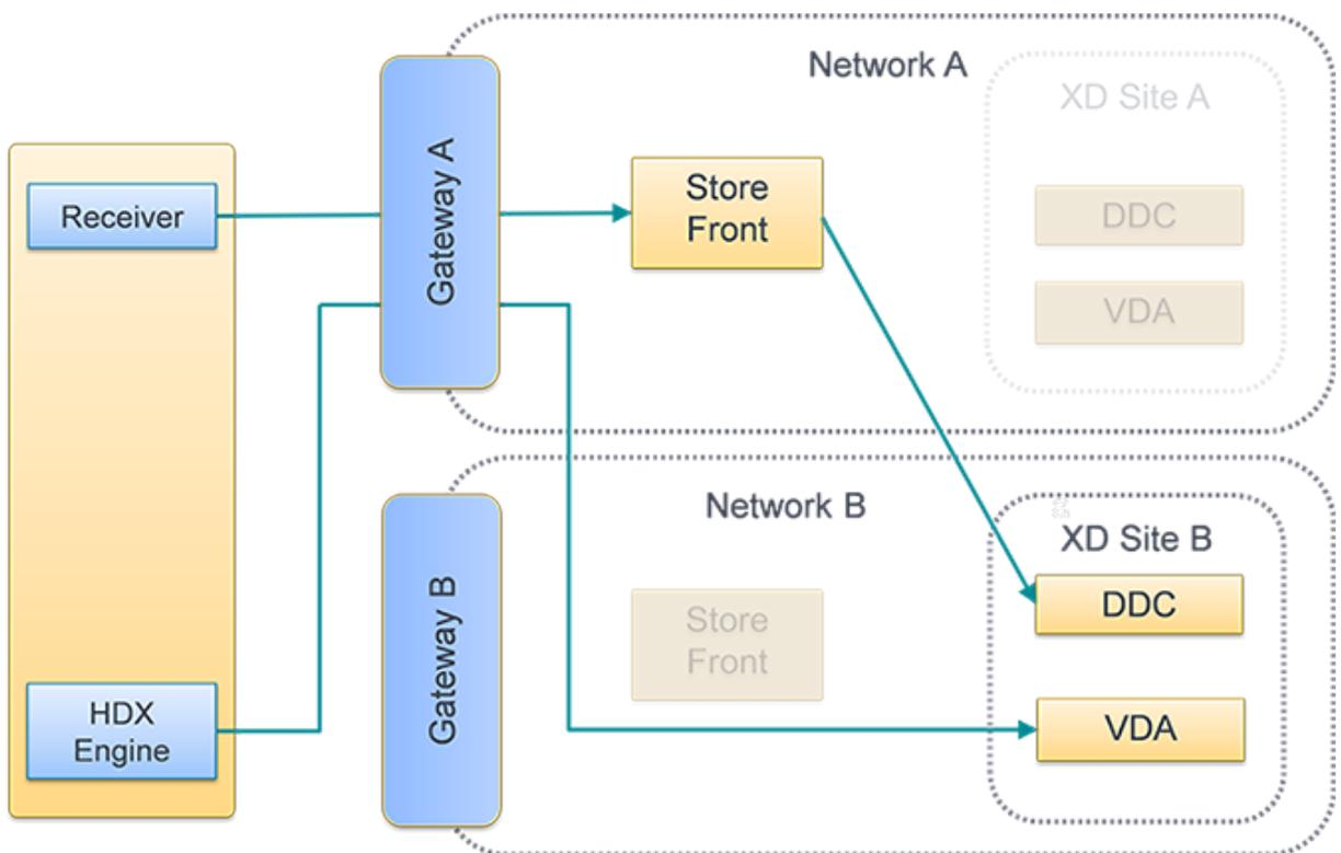
Abbildung 2. Optimales Gatewayrouting
