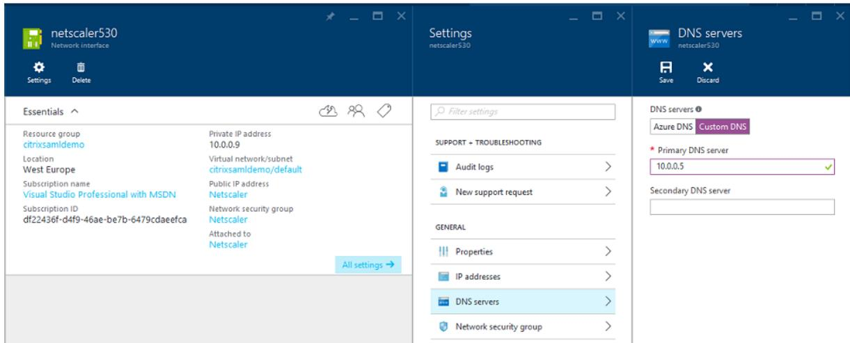
De forma predeterminada, la dirección IP interna (10.0.0.9) se asigna dinámicamente. Puede usar el parámetro de direcciones IP para asignar permanentemente la dirección IP. Esto debe hacerse para el servidor proxy de aplicaciones web y el controlador de dominio.
