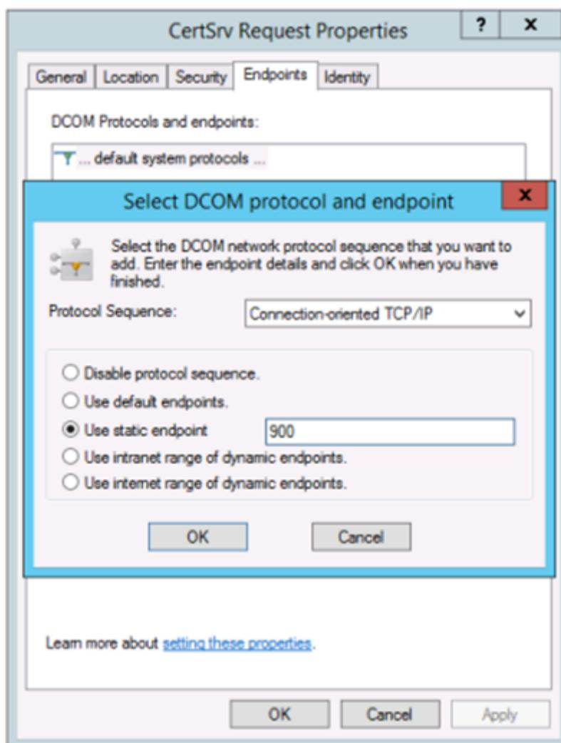
Cambie los “puntos finales” para seleccionar un dispositivo de punto final estático y especifique un número de puerto TCP (900 en la imagen de arriba).
