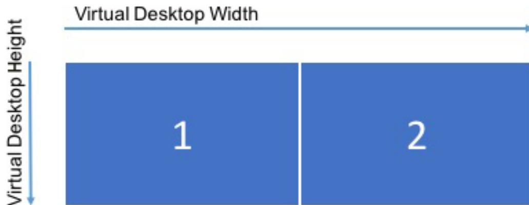
El diagrama anterior muestra una configuración con varios monitores lista para usar con dos monitores, cada uno con una resolución de  $2560 \times 1600$ .
