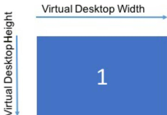
En este ejemplo, el escritorio virtual debe configurarse en un tamaño de 2560 × 1600. Como la configuración predeterminada es de 5120 x 1600 y 2 monitores, se requiere un cambio de configuración para optimizar el uso de la memoria en las implementaciones de un solo monitor.
