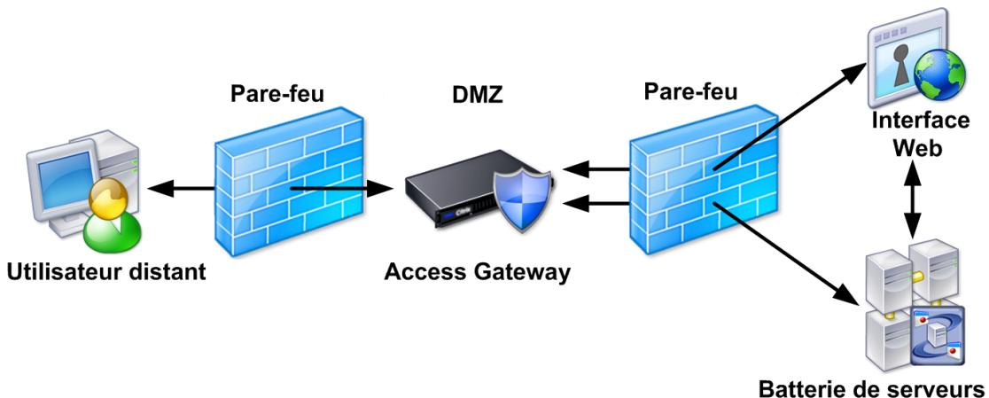
Une DMZ est un sous-réseau compris entre le réseau interne sécurisé et Internet (ou tout réseau externe). Lorsqu'Access Gateway est déployé dans la DMZ, les utilisateurs y accèdent à l'aide de Citrix Secure Access Plug-in ou d'un client Citrix. Les utilisateurs ouvrent une session, sont authentifiés par Access Gateway et ensuite dirigés vers leurs ressources, en fonction des stratégies d'accès que vous avez configurées.
