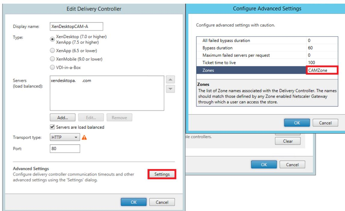
Configurez un routage NetScaler Gateway optimal afin d'optimiser le traitement du routage de la connexion ICA depuis le moteur HDX vers des ressources publiées telles que des VDA XenDesktop ou des applications publiées XenApp ou XenDesktop à l'aide de StoreFront. En général, la passerelle optimale pour un site figure dans le même emplacement géographique.
