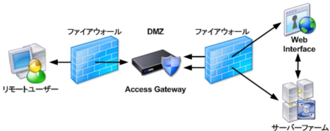
DMZは、保護された内部ネットワークとインターネット（または任意の外部ネットワーク）間にあるサブネットです。Access GatewayをDMZに展開する場合、ユーザーはCitrix Secure Access Plug-inまたはCitrixのクライアントを使ってこれにアクセスします。ユーザーのログオンはAccess Gatewayにより認証され、構成するアクセスポリシーに基づいてリソースが表示されます。
