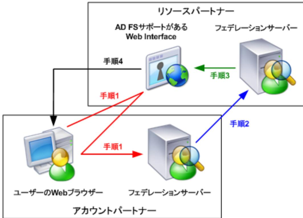
手順4： Web Interfaceは、そのユーザーがアクセスできるアプリケーションセットを表示します。この図は、アカウントパートナードメインのユーザーがログオンし、アプリケーションセットにアクセスするときの手順を示しています。
