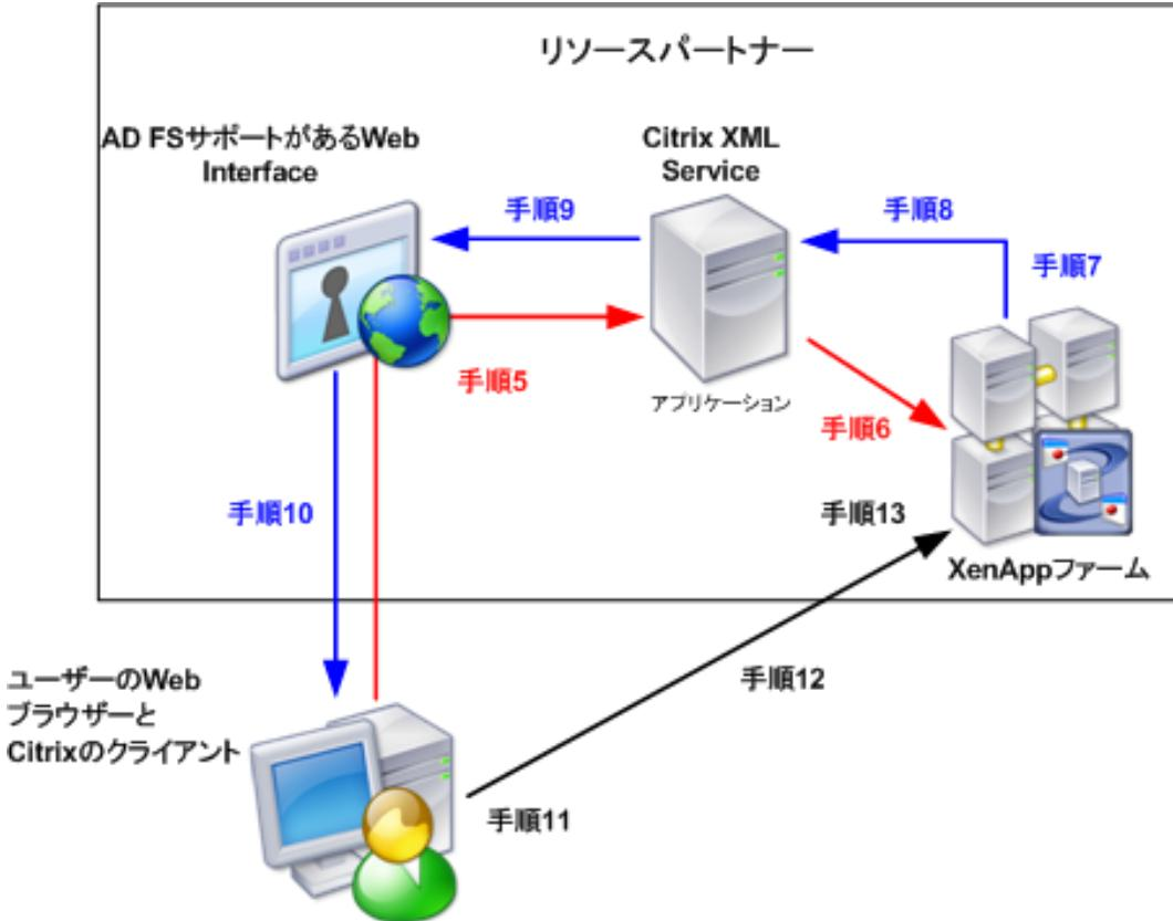
手順13：XenAppサーバーが起動チケットを受け取り、そのチケットを前の手順で作成したログオントークンと照合します。次に、そのトークンを使って、そのサーバー上のICAセッションにユーザーがログオンできるようにします。ICAセッションは、シャドウアカウントの識別情報を使って実行されます。この図は、アカウントパートナードメインのユーザーがアプリケーションにアクセスするときの手順を示しています。
