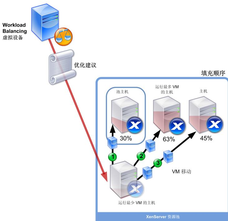
此图解释了在“最大密度”模式下，在主机上合并 VM 时，XenServer 将尝试首先填充池主服务器，然后填充负载最高的主机，最后填充负载最低的主机。
