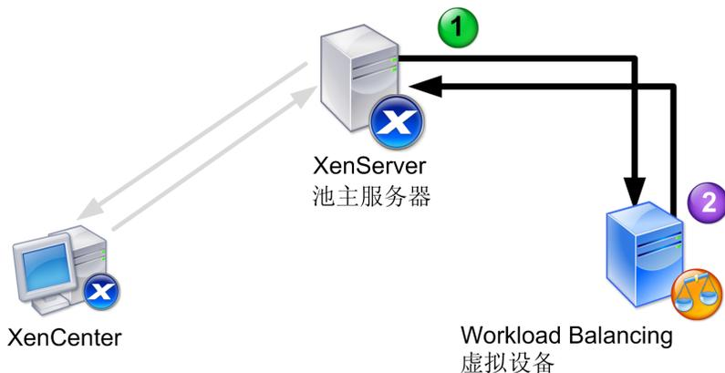
此图显示了：(1) XenServer 如何使用您在 Workload Balancing 配置期间创建的帐户与 Workload Balancing 通信，以及 (2) Workload Balancing 虚拟设备如何使用池的凭据向 XenServer 进行身份验证。
