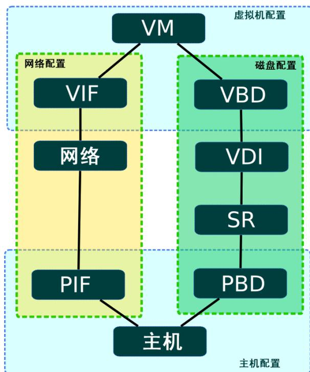
管理 VM、主机、存储和网络连接的 API 类的图表概述
