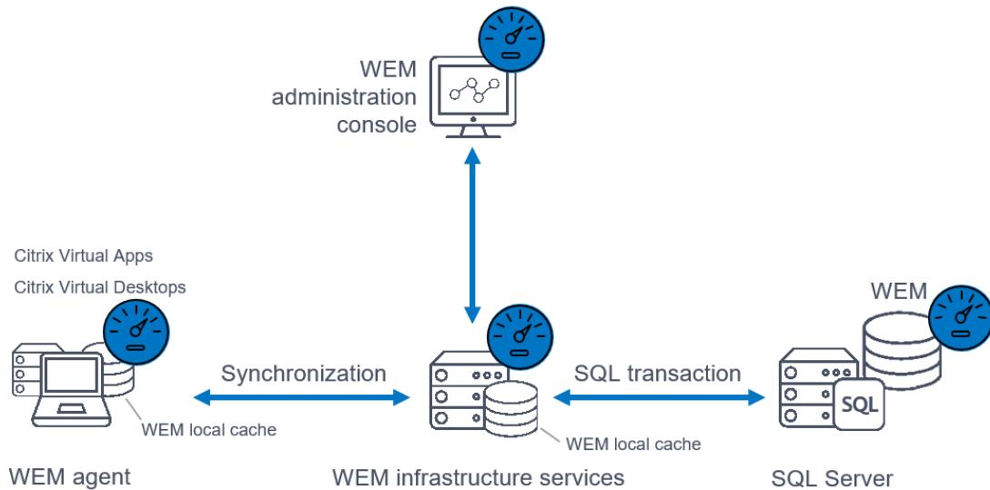
基础设施服务。基础设施服务安装在多会话操作系统上。它们将各种后端组件（SQL Server 和 Active Directory）与前端组件（管理控制台和代理）同步。
